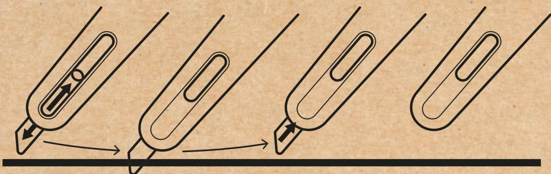
La cuchilla se retrae automáticamente cuando pierde contacto con el material de corte, incluso si aún tiene su dedo en el deslizador.
