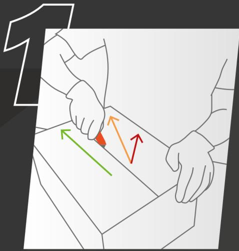
El corte debe de ser en un ángulo inclinado de 45 grados hacia afuera del cuerpo.
