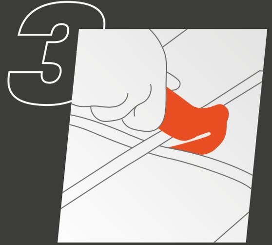
En el uso de cutter tipo pato el corte para fleje debe ser a 45°, siempre hacia abajo.
